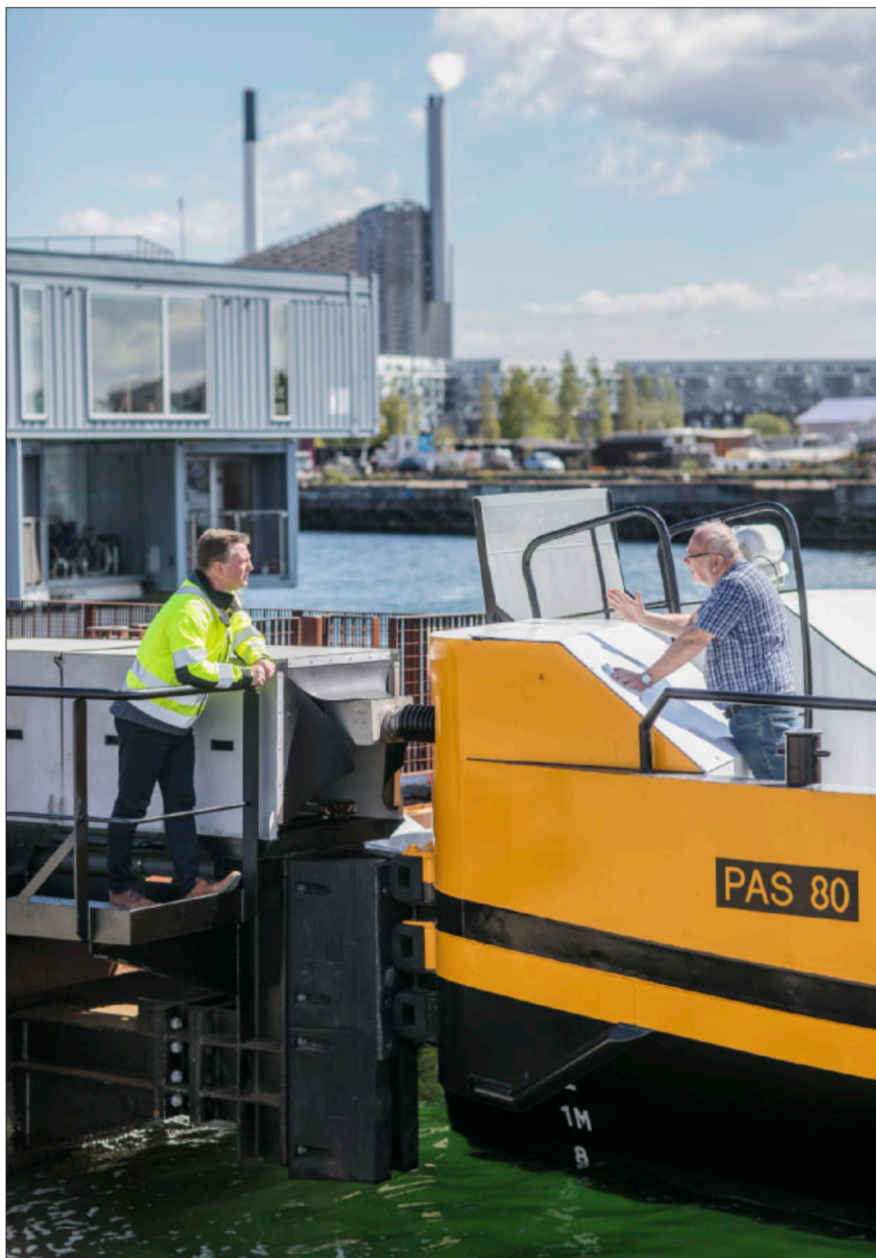
De københavnske vandbusser lynlades hver gang, de er fremme ved en endestation. Foto: Melissa Ørnstrup
